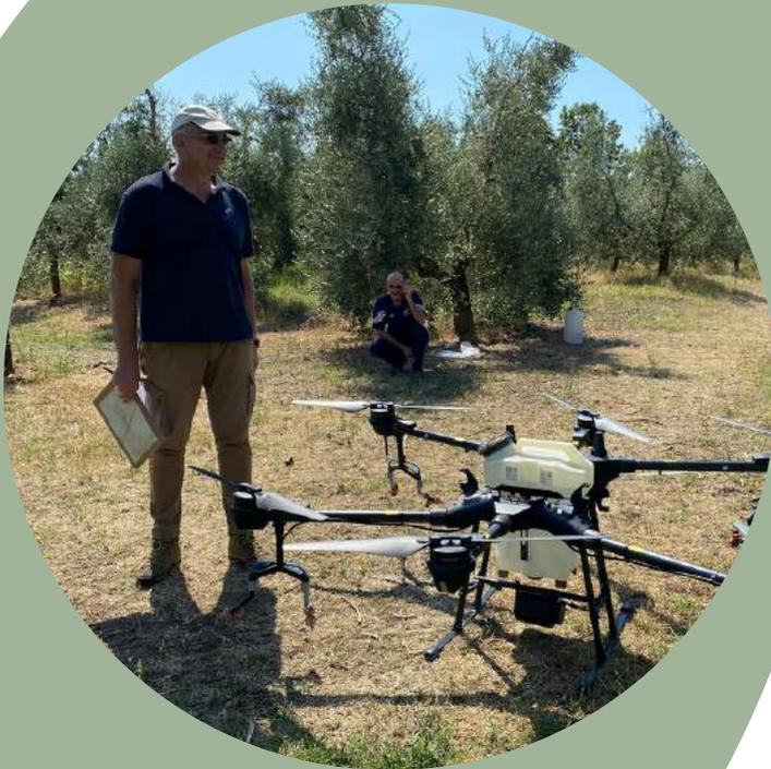
*Figura 19. Drone per la distribuzione di insetticidi*
